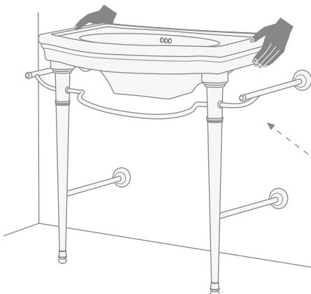
**10)** Mantenendo il lavabo in posizione corretta con l'aiuto della livella, tracciare i fori per il fissaggio delle staffe ad "S" di supporto del lavabo.
