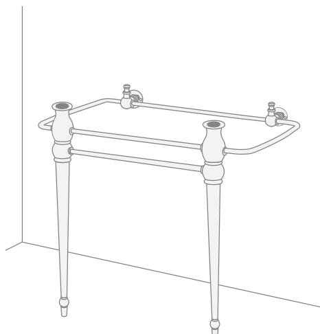
**8)** Mit Hilfe einer Wasserwaage die Positionierung der Struktur sowohl parallel als auch rechtwinklig zur Wand nachprüfen.
