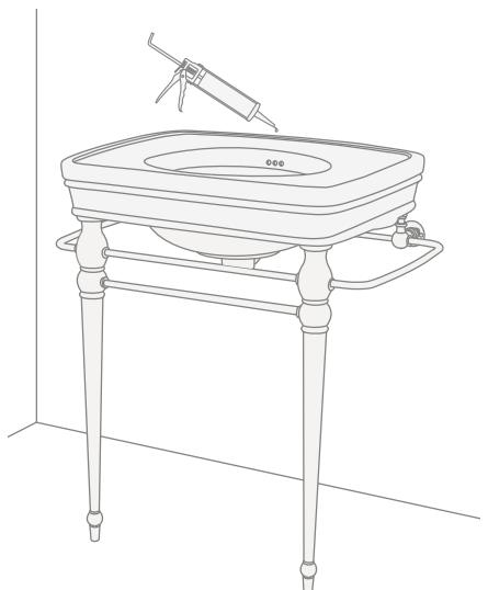
**15)** Vuelva a colocar el lavabo, poniendo la parte trasera entre las abrazaderas y la pared.
