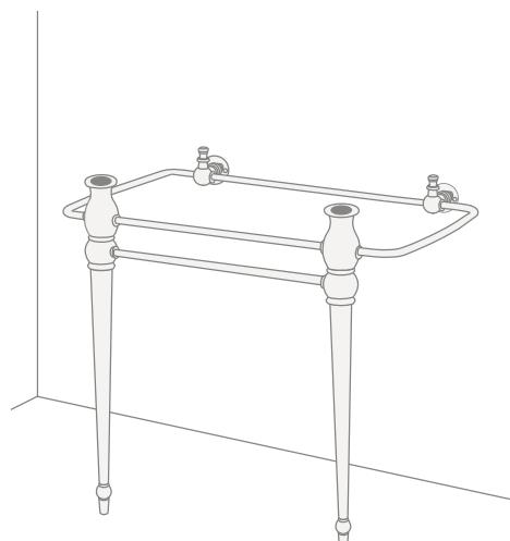
**8)** Vérifiez le positionnement de la structure à l'aide d'un niveau dans la direction parallèle ainsi qu'orthogonale au mur.
