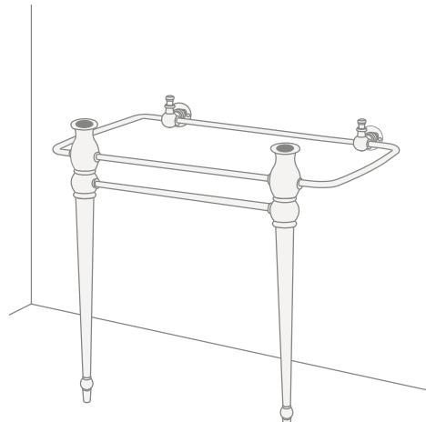
**8)** Уровнем проверить параллельность и перпендикулярность положения структуры относительно стены.
