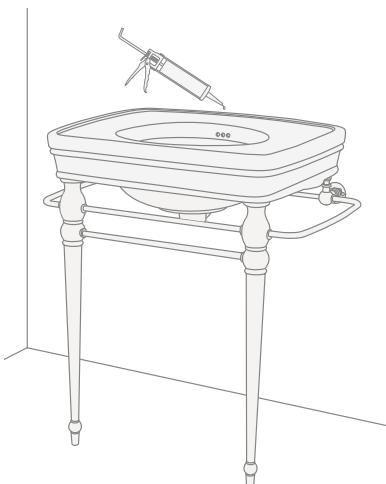
**15)** Das Waschbecken erneut anbringen, indem man den rückwärtigen Teil zwischen den Bügel und der Wand einlegt.
