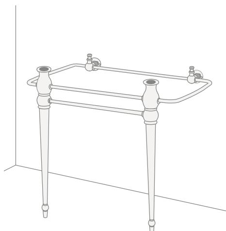
**8)** Controle la posición de la estructura utilizando un nivel en sentido tanto paralelo como ortogonal en la pared.
