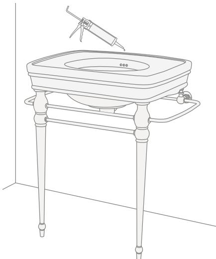
**15)** Вновь установить раковину, навесив её задней частью на держатели, чтобы она плотно прилегла к стене.
