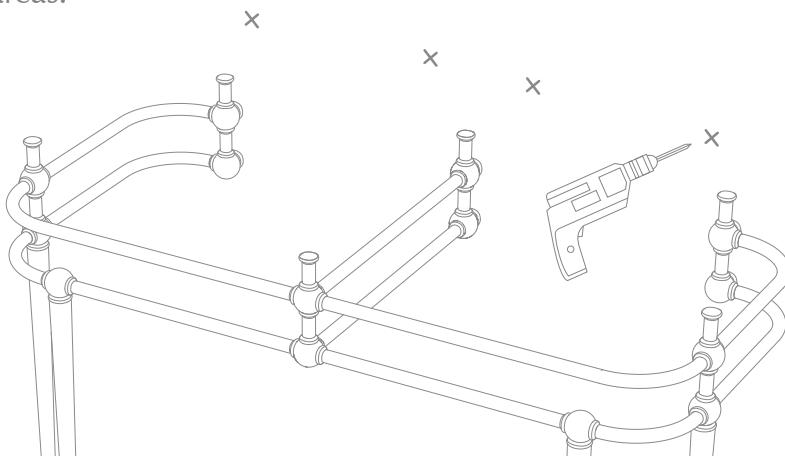
**11)** Introduzca los tacos en los agujeros, vuelva a colocar el lavabo y fíjelo utilizando los tornillos y las arandelas de plástico específicas (H+I) también proporcionadas).
