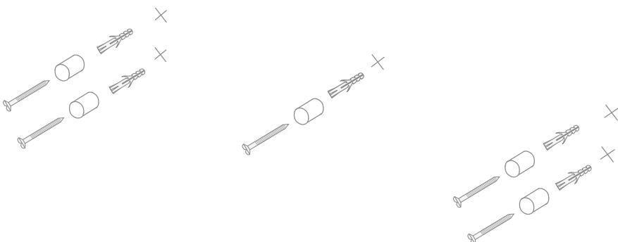
7) Прислоните консоль к стене и вставьте ее в пять ранее установленных элементов крепления.
