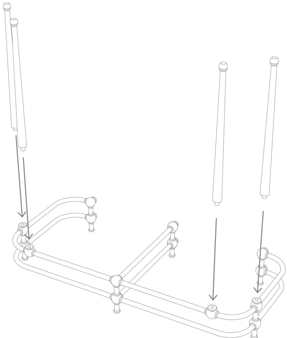
**4)** Ahora se puede volcar la consola, con las cuatro patas recién montadas, y apoyarla en la pared. Utilice el patrón de cartón (L: proporcionado) para marcar los puntos de fijación de la misma.
