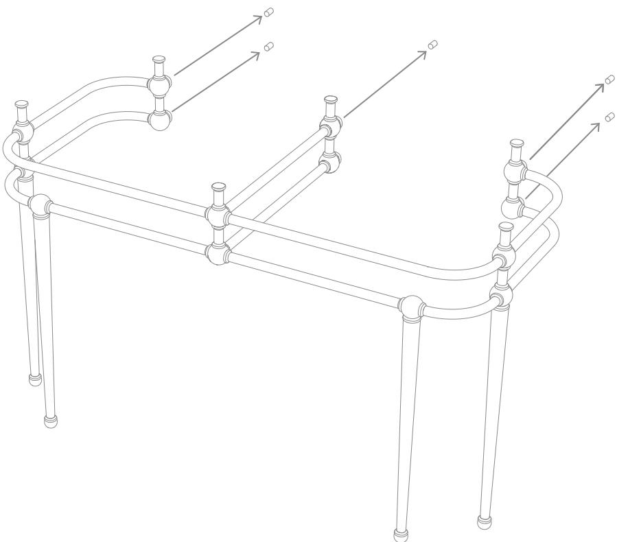
**8)** A questo punto è necessario fissare definitivamente la consolle. Serrare, con la chiave a brugola (F), i 5 grani (E) forniti nei punti indicati nella figura sottostante.
