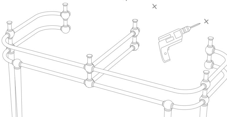
**11)** Inserire i tasselli nei fori, posizionare di nuovo il lavabo e fissarlo con le viti e le rondelle di plastica apposite (H+I) anch'esse fornite in dotazione).
