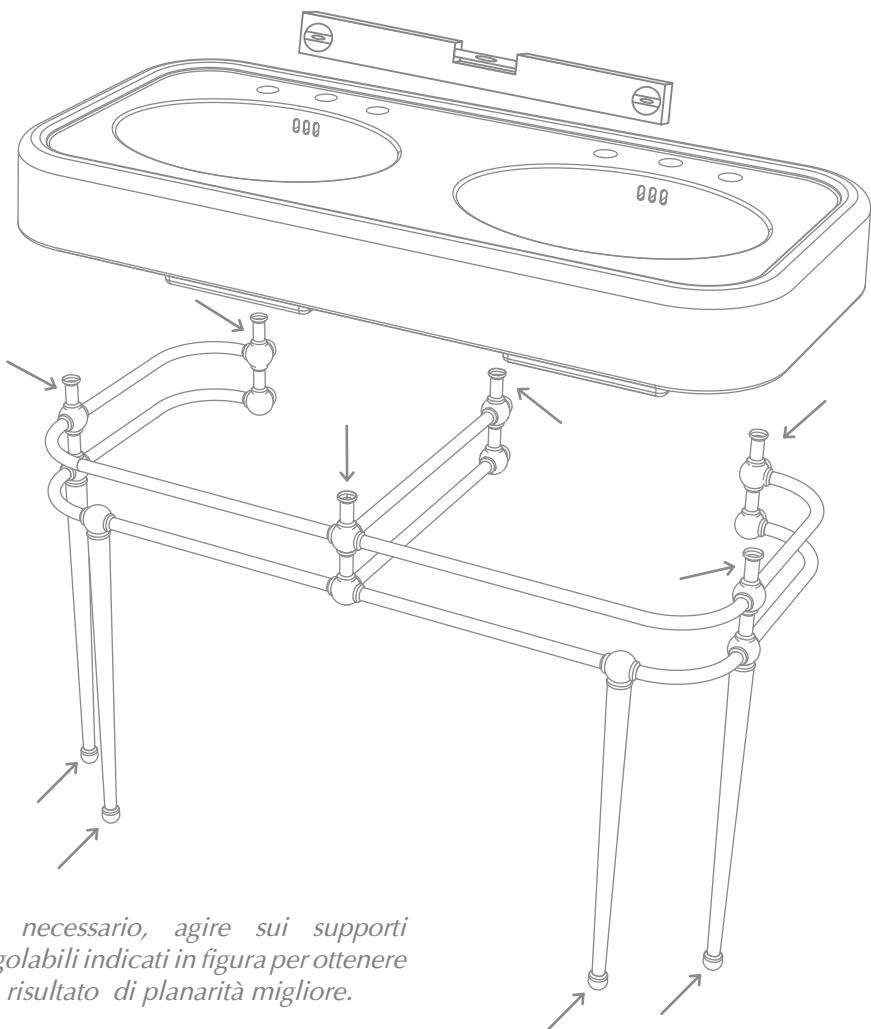
*Se necessario, agire sui supporti regolabili indicati in figura per ottenere un risultato di planarità migliore.*
