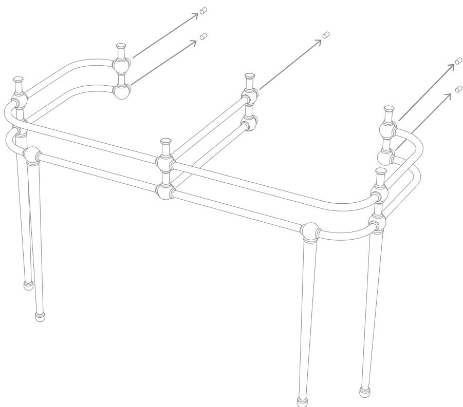
8) После этого нужно окончательно закрепить консоль. Затянуть торцевым ключом (F), 5 поставляемых в комплекте стопорных винта (E) в точках, указанных на приведенном ниже рисунке.
