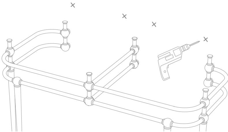
11) Вставьте пробки в отверстия, снова уложите раковину и закрепите ее винтами со специальными пластмассовыми шайбами (H+I) - поставляемыми в комплекте).
