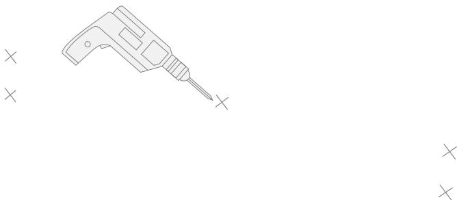
**6)** Introduzca en los cinco agujeros los tacos, el elemento de fijación de la consola y el tornillo (C+D) todos los elementos se proporcionan).
