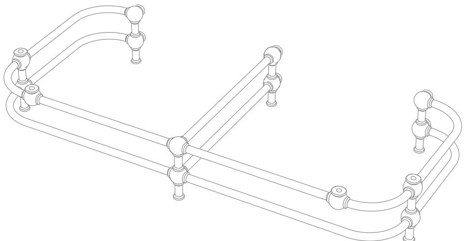
**3)** Avvitare le quattro gambe della consolle (B) nei punti indicati della struttura.
