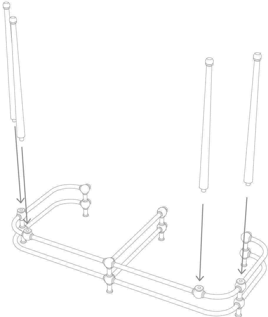
**4)** Maintenant il est possible de retourner la console, avec les quatre pieds qui viennent d'être montés, et de l'adosser contre la paroi. Utiliser le gabarit en carton (L : fourni) pour marquer les points de fixation de la console.
