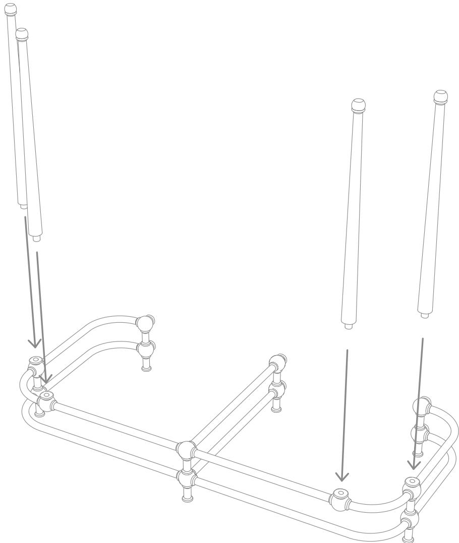
4) Теперь можно опрокинуть консоль, с четырьмя ранее установленными ножками, и прислонить ее к стене. При помощи картонного шаблона (L: поставляется в комплекте), отметьте точки крепления консоли.
