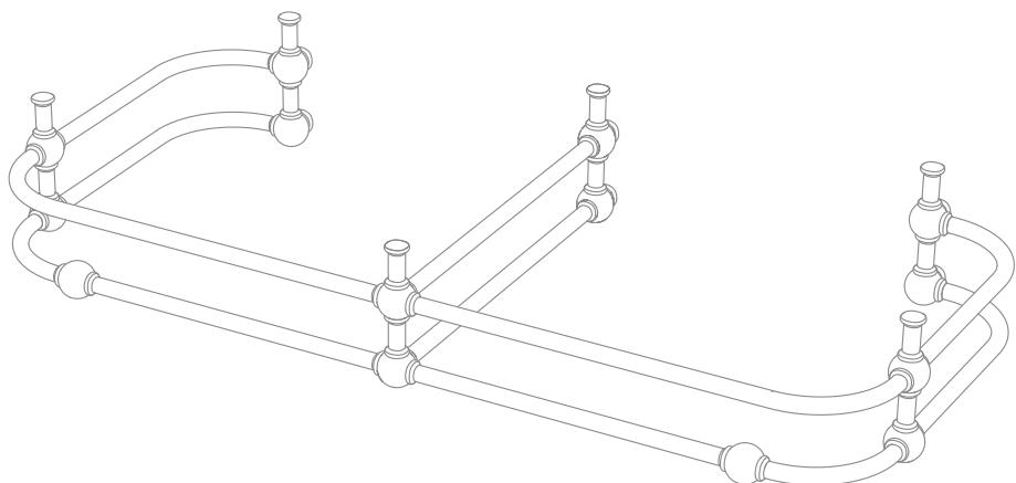
2) Осторожно опрокиньте структуру чтобы предотвратить ее повреждение в процессе монтажа.
