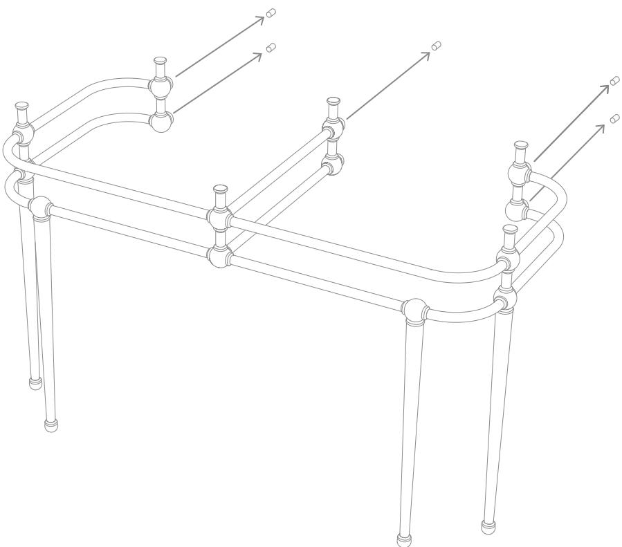
**8)** A este punto, es necesario fijar definitivamente la consola. Apriete, utilizando la llave Allen (F), las 5 clavijas (E) proporcionadas en los puntos indicados en la figura de abajo.
