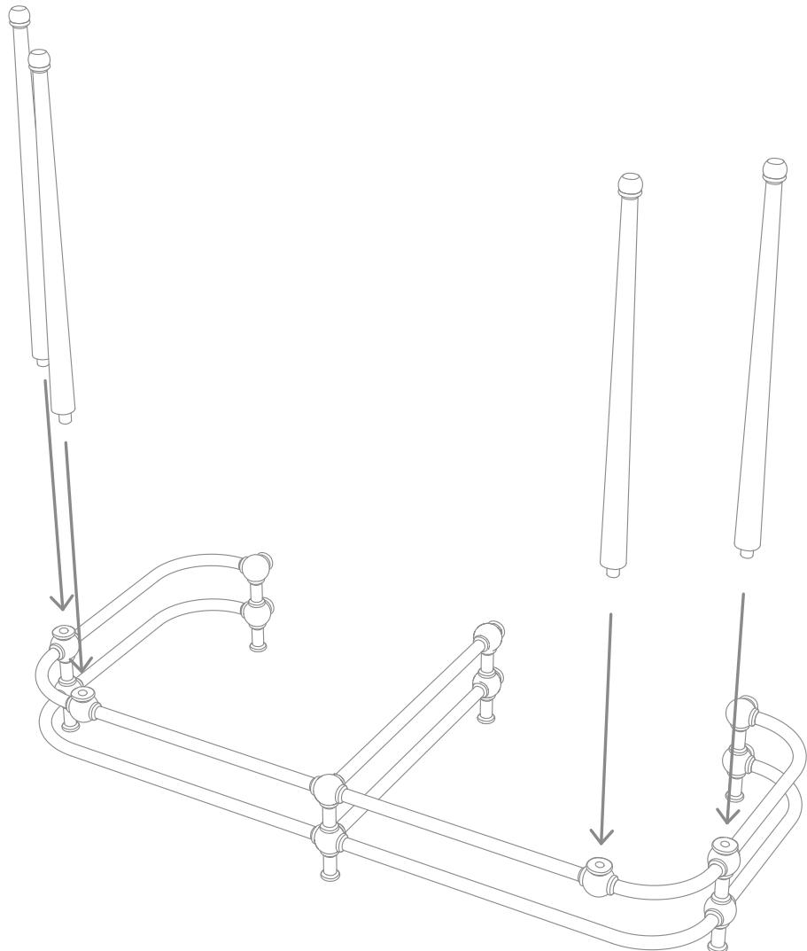
**4)** Nun kann man die Konsole mit den eben montierten vier Beinen umdrehen und sie an die Wand halten. Mit Hilfe der Kartonschablone (L: im Lieferumfang enthalten) die Punkte für die Befestigung der Konsole anzeichnen.
