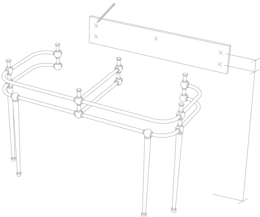
*Genau auf die richtige Position der Schablone an der Wand achten, bevor die Bohrungen ausgeführt werden.*
