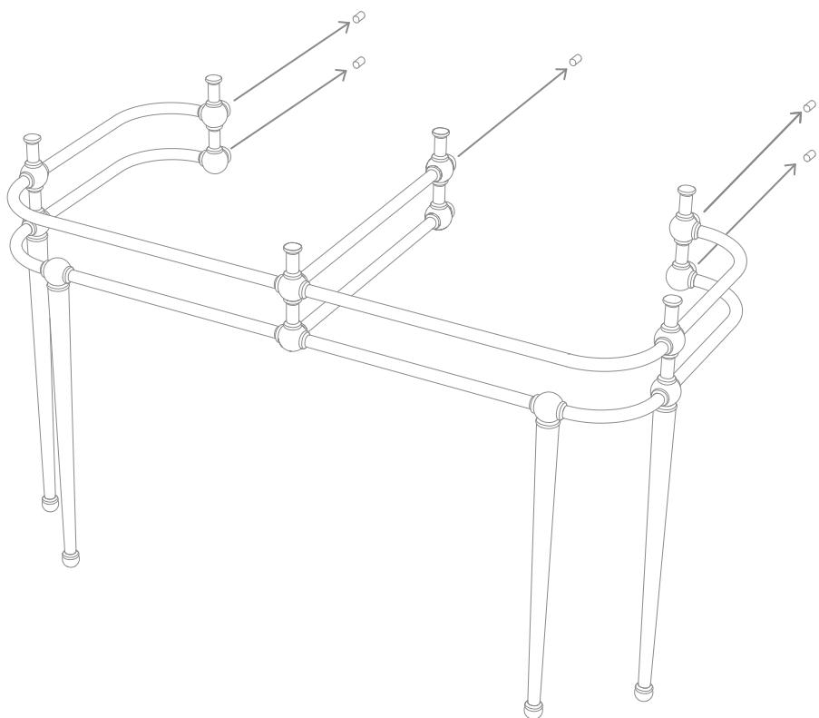
8) Nun muss die Konsole endgültig befestigt werden. Mit dem mitgelieferten Inbusschlüssel (F) und den 5 Stiften (E) an den Punkten, die in der Abbildung unten angegeben sind, festziehen.
