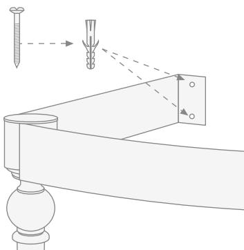
**8)** Das Waschbecken Westminster auf die Struktur setzen und einen guten Kompromiss zwischen der Auflage auf der Struktur und an der Wand herstellen.
