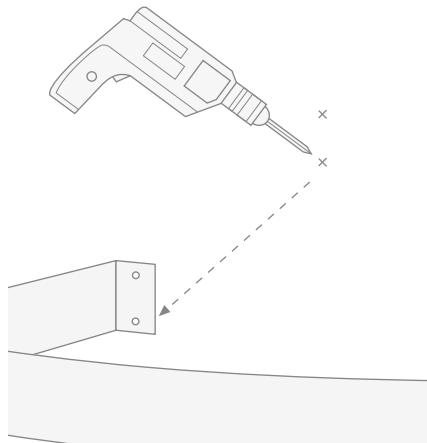
**7)** Die mitgelieferten Dübel in die Löcher einsetzen. Die Struktur wieder an die Wand stellen und mit den mitgelieferten Schrauben befestigen.
