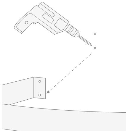
**7)** Introduzca los tacos proporcionados en el equipo en los agujeros. Vuelva a colocar toda la estructura en la pared y fíjela con los tornillos, también proporcionados en el equipo.
