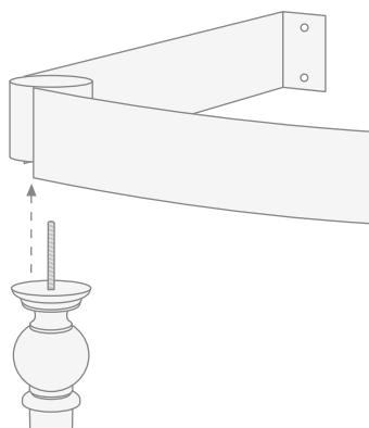
**3)** Avvitare sulla barra filettata il supporto dalla parte opposta della struttura fino al bloccaggio della gamba. Ripetere queste operazioni per entrambe le gambe.
