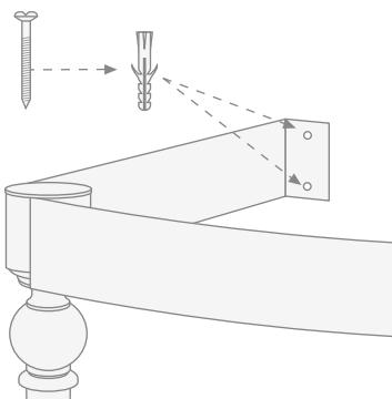
**8)** Apoye el lavabo Westminster sobre la estructura, buscando un buen equilibrio entre el apoyo sobre la estructura y el apoyo sobre la pared.
