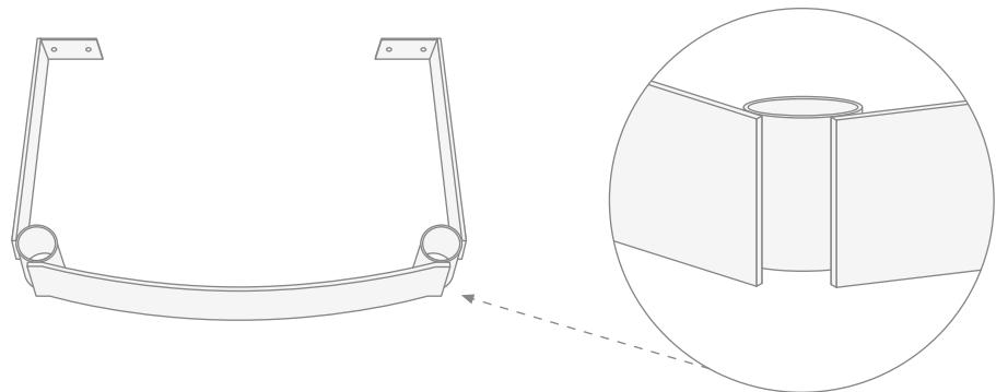
**2)** Inserire la gamba con la sua barra filettata nella struttura in modo che la gamba arrivi a battuta dalla parte inferiore della struttura.
