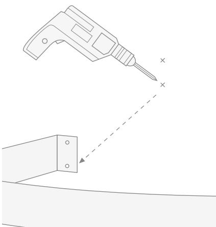
**7)** Вставить дюбеля в отверстия, снова приставить конструкцию и закрепить соответствующими винтами.
