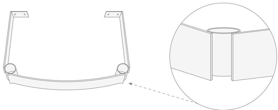
**2)** Introduzca la pata con su barra roscada en la estructura, de manera que la pata llegue hasta el tope por la parte inferior de la estructura.
