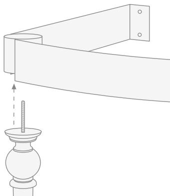
**3)** Навинтить на резьбовой штырь суппорт с другой стороны конструкции до полной блокировки ножки. Выполнить то же самое с другой ножкой.
