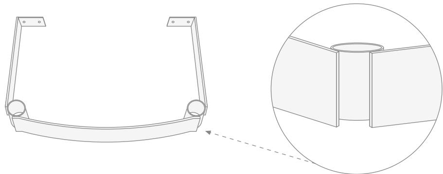
**2)** Das Bein mit seiner Gewindestange in den Unterteil der Struktur auf Anschlag einsetzen.
