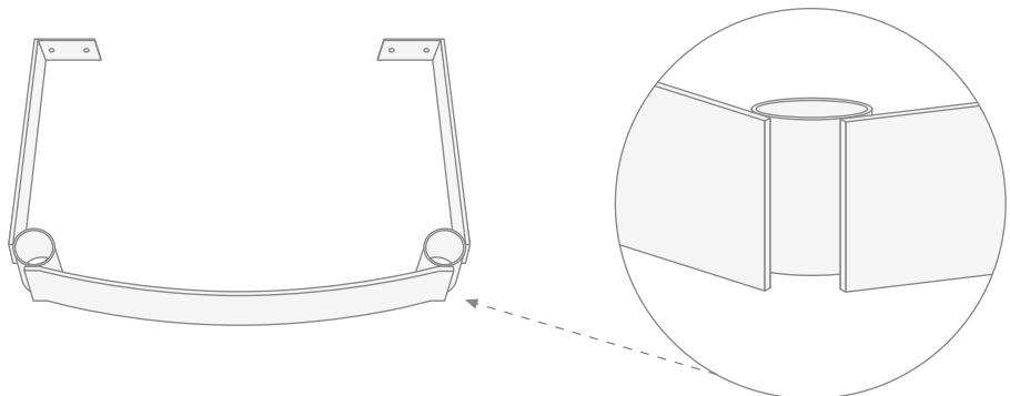
**2)** Вставить ножку резьбовым штырем с нижней стороны конструкции таким образом, чтобы она вошла до упора.
