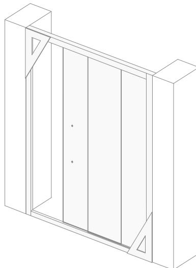
**9)** Para colocar los tornillos (E), haga cuatro agujeros, usando una broca para hierro ( $\varnothing$  2,5mm,) en los montantes de la puerta de la ducha en cuatro puntos (dos en la parte de arriba, y dos en la de abajo).
