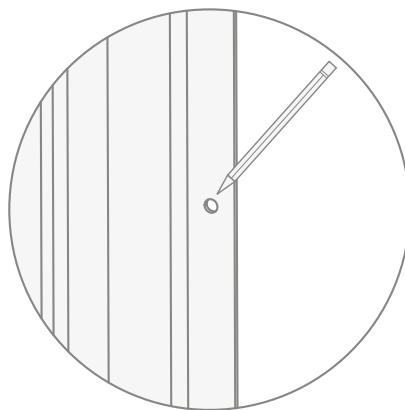
**4)** Enlever les profilés compensatoires et percer à hauteur des quatre points marqués auparavant.
