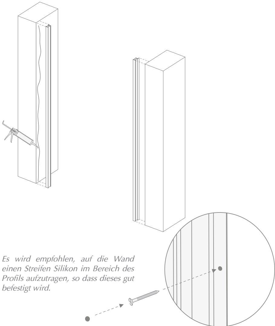
**7)** Die Duschtür zentrieren (dabei den verschiebbaren Teil geschlossen halten), dafür den Türrahmen auf den festen Profilen verschieben und dann mit den mitgelieferten selbstschneidenden Schrauben von innen blockieren.
