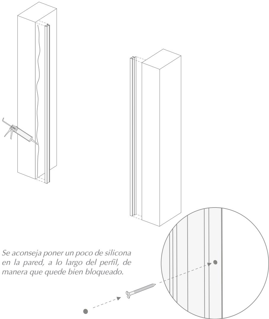
**7)** Centre la puerta de la ducha (con la parte corredera cerrada), colocando el marco de la puerta en los perfiles fijos y bloqueando el conjunto con los tornillos taladradores (proporcionados con el kit) desde el interior.
