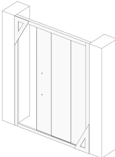
**9)** Per posizionare le viti (E), pre-forare, con una punta a ferro ( $\varnothing$  2,5mm) i montanti della porta doccia in quattro punti (due bassi e due alti).
