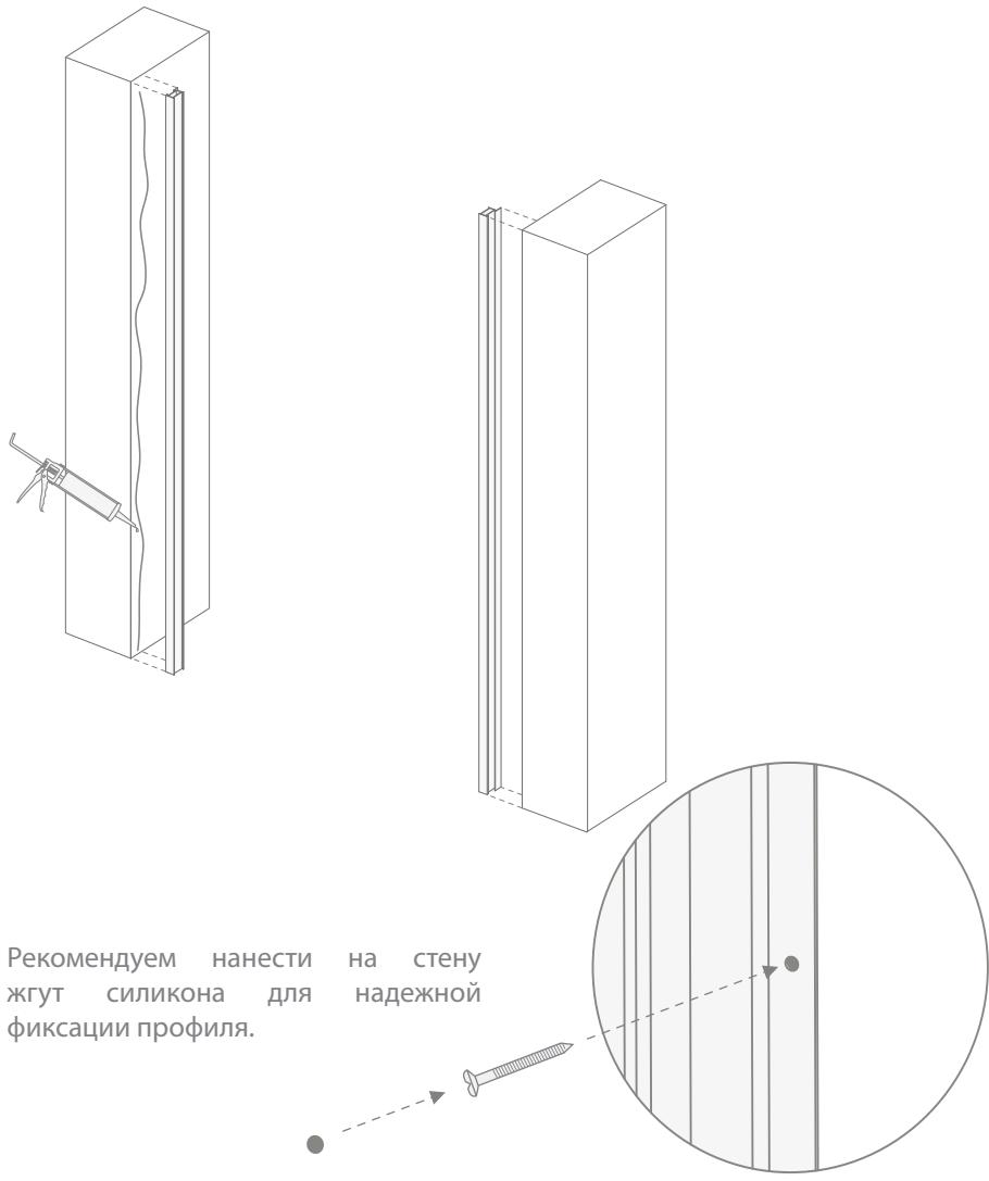
7) Отцентрируйте створку двери (удерживая в закрытом состоянии раздвижную часть), путем перемещения рамы двери по неподвижным профилям и закрепите все изнутри саморезными шурупами (поставлены в комплекте).
