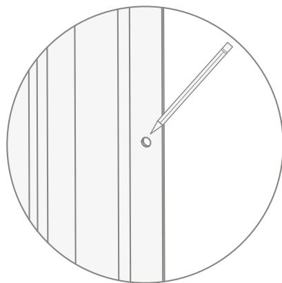
4) Снять компенсирующие профили и просверлить отверстия напротив ранее отмеченных четырех точек.
