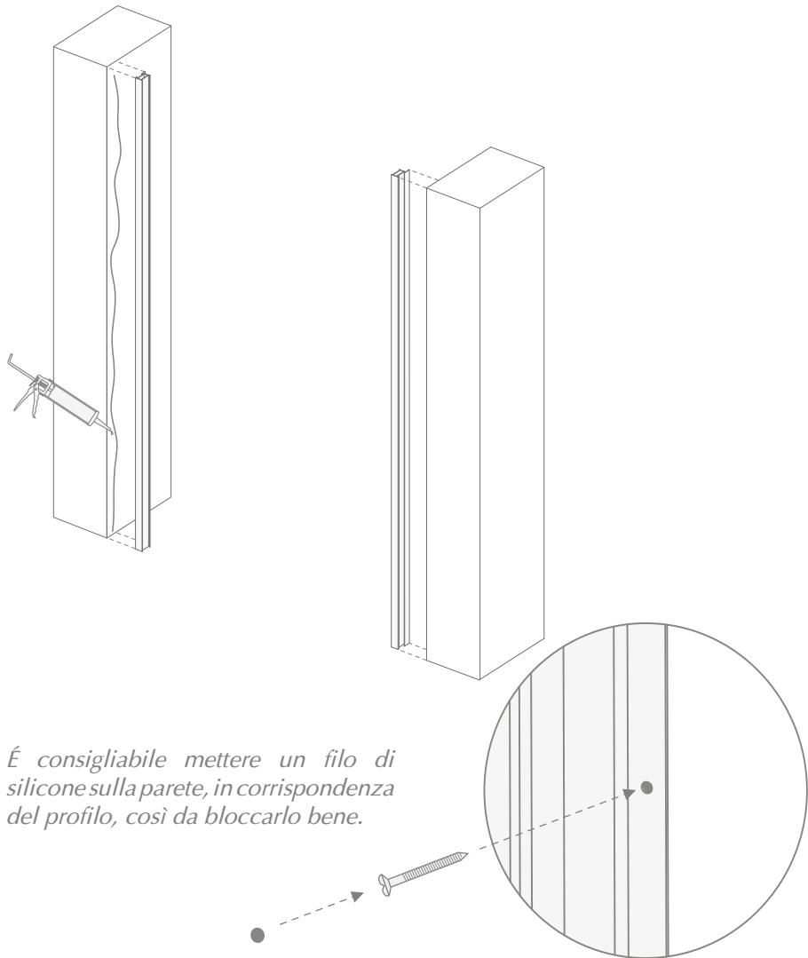
**7)** Centrare la porta doccia (tenendo chiusa la parte scorrevole), facendo scorrere il telaio della porta sui profili fissi e bloccare tutto con le viti autofilettanti (in dotazione) dall'interno.
