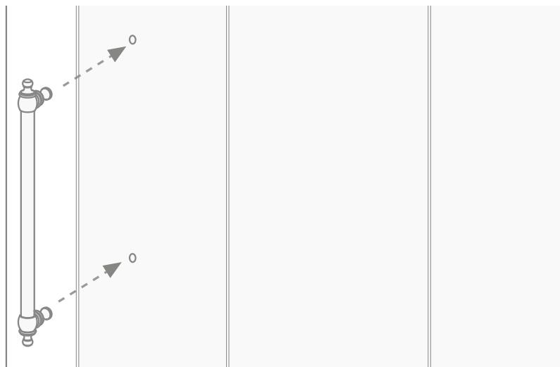
**12)** Nun kann der Griff von innen blockiert werden, indem man die vorher abgeschraubten Teile von beiden Seiten wieder anschraubt.
