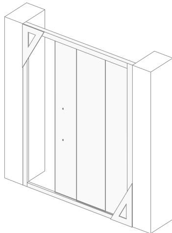
9) Для установки шурупов (E), предварительно просверлите сверлом для металла ( $\varnothing$  2,5 мм) стойки двери душа в четырех точках (две снизу и две сверху).
