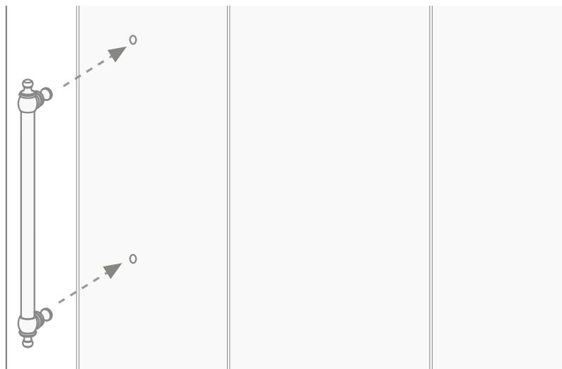
**12)** Теперь можно зафиксировать ручку изнутри путем завинчивания ранее снятых с обеих сторон частей.
