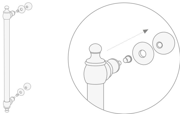
**11)** Den Griff (H) in die vorhandenen Bohrungen an der Scheibe der Duschtür einsetzen (verschiebbar).
