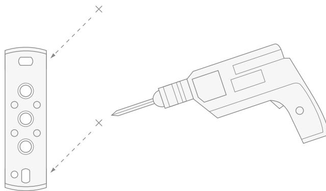
**4)** Inserire i tasselli a muro, posizionare la piastra e fissarla a muro avendo cura di far passare i cavi della rete di alimentazione dal foro apposito.
