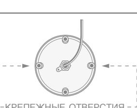
Крепление светильника Julia без держателя: два крепежных отверстия находятся непосредственно в корпусе светильника.
