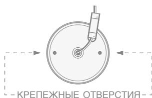
Крепление светильника Dover без держателя: два крепежных отверстия находятся непосредственно в корпусе светильника.
