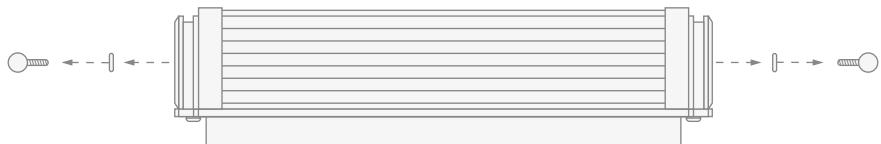
Quite el cristal de la lámpara desenroscando los dos pomos (con sus correspondientes arandelas) que se encuentran en los extremos de la lámpara.
