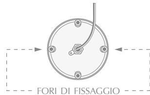
Fissaggio per lampada Julia privo di piastra: sono presenti due fori di fissaggio direttamente sul corpo della lampada.
