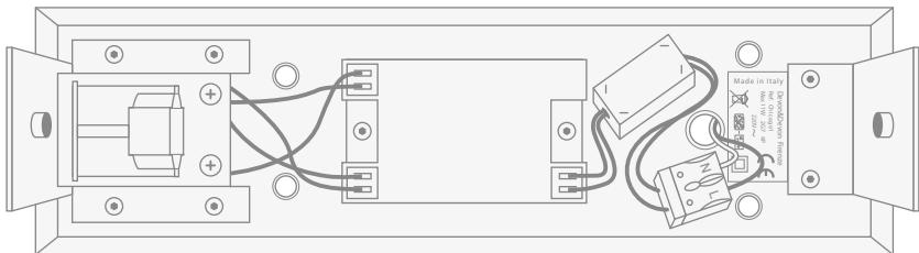
Es wird darauf hingewiesen, dass es sich um ein Gerät der Klasse II handelt und daher kein Anschluss an eine Erdklemme erforderlich ist.
