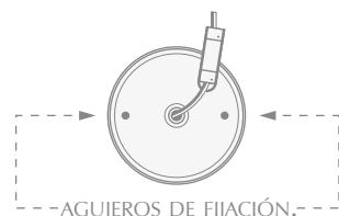
Fijación para lámpara Dover sin pletina: hay dos agujeros de fijación en el cuerpo de la lámpara.
