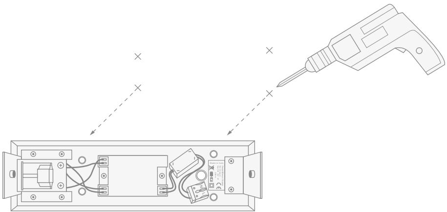
**4)** Вставить дюбеля, приставить светильник задней стороной к стене и прикрепить, пропустив электропровода сети через специальное отверстие.
