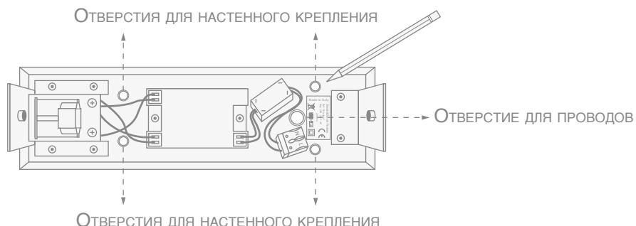
**3)** Отнять светильник от стены и просверлить отверстия по меткам.
