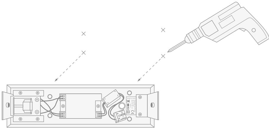
**4)** Insérer les chevilles dans le mur, positionner la partie supérieure de la lampe et la fixer au mur, en veillant à faire passer les câbles du réseau d'alimentation à travers le trou.
