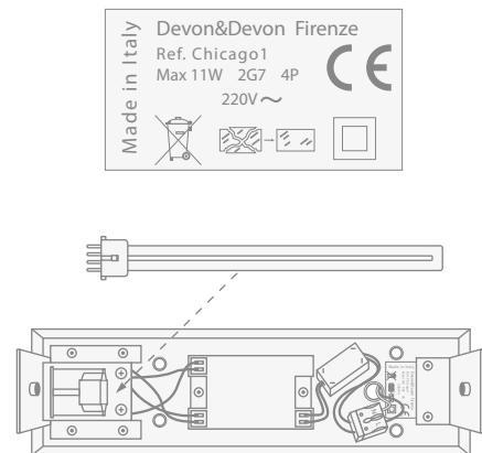
**7)** Monter à nouveau le verre de la lampe, le bloquant avec les deux pommeaux. Fermer l'interrupteur d'alimentation du réseau et vérifier le fonctionnement correct de l'appareil.
