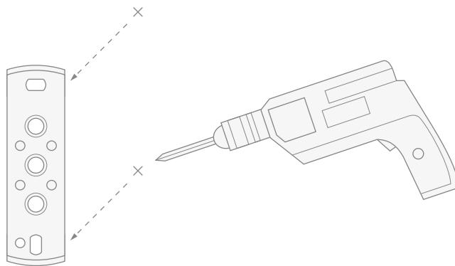
**4)** Вставить дюбеля в отверстия в стене, приставить держатель и прикрепить к стене, пропустив электропровода через специальное для этого отверстие.
