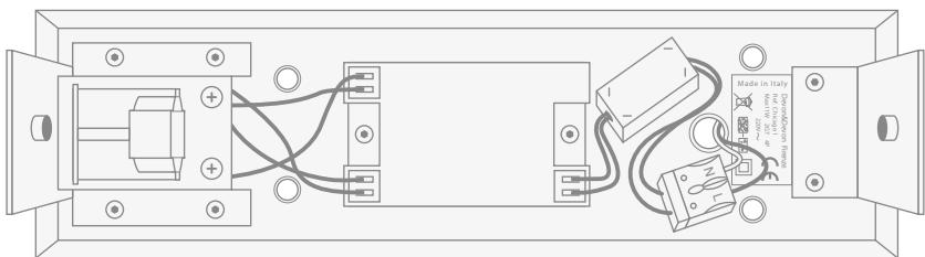
Vi ricordiamo che l'apparecchio è in classe II e quindi non è necessario il collegamento al terminale di terra.
