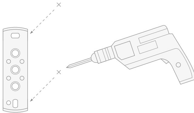
**4)** Die Wanddübel einsetzen, die Platte positionieren, an der Wand befestigen und dabei darauf achten, dass die Netzkabel durch das entsprechende Loch gezogen werden.
