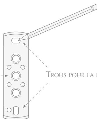
**3)** Enlever la plaque et réaliser les trous dans le mur selon le traçage qui vient d'être effectué.
