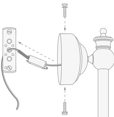
**8)** Рядом с крепежным отверстием в нижней части корпуса светильника имеются два других отверстия: одно для крепления, а другое предназначено для обеспечения степени защиты IP21 при помощи специального дополнительного набора.
