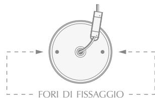
Fissaggio per lampada Dover privo di piastra: sono presenti due fori di fissaggio direttamente sul corpo della lampada.
