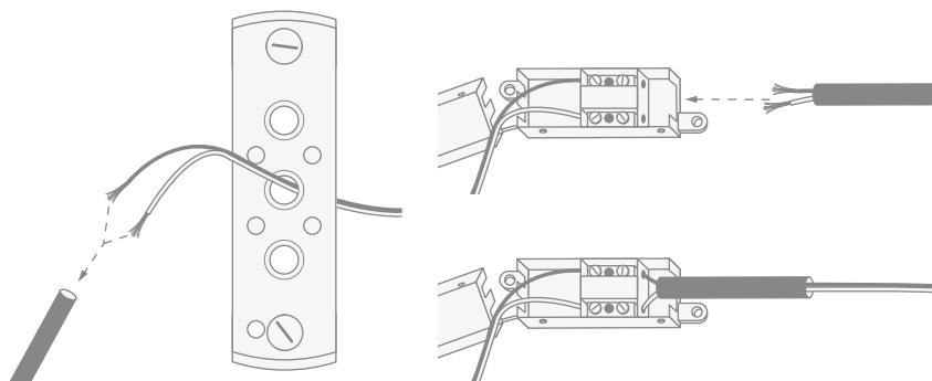
Vi ricordiamo che l'apparecchio è in classe II e quindi non è necessario il collegamento al terminale di terra.
