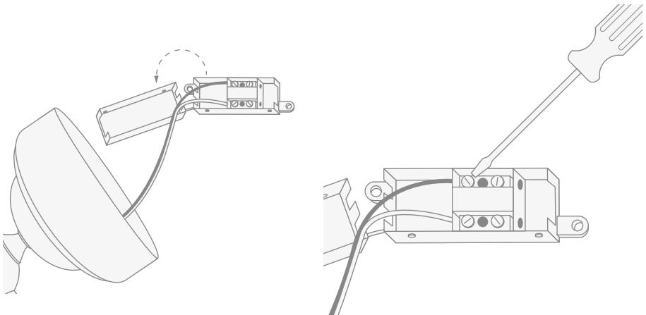
**6)** Провода силовой сети сначала нужно пропустить через черный блок и затем вставить проводники в зажимы, соединив правильно фазы (коричневый провод) и нейтрали (голубой провод).
