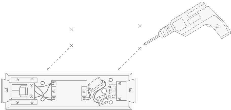
**4)** Introduzca los tacos, coloque la parte trasera de la lámpara y fíjela en la pared, teniendo cuidado en hacer pasar los cables de la red eléctrica por el específico agujero.
