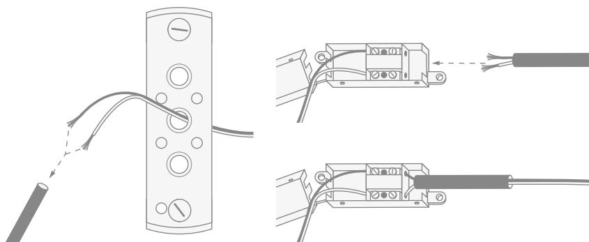
Es wird darauf hingewiesen, dass es sich um ein Gerät der Klasse II handelt und daher kein Anschluss an eine Erdklemme erforderlich ist.
