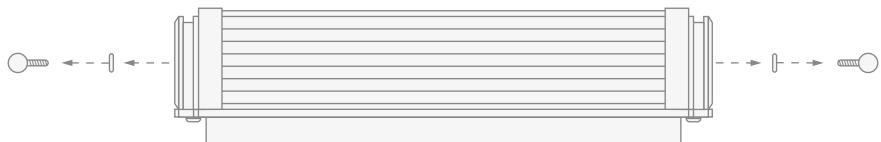
Das Glas durch Losschrauben der beiden Kugelknöpfe (und der jeweiligen Unterlegscheiben) am Rand der Leuchte abnehmen.
