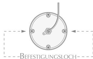
Befestigung für Leuchte Julia ohne Platte: es sind zwei Befestigungsbohrungen direkt am Gehäuse der Leuchte vorhanden.
