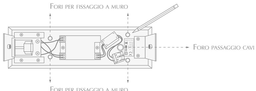
**3)** Rimuovere la parte posteriore della lampada ed eseguire le forature a muro secondo la tracciatura appena eseguita.
