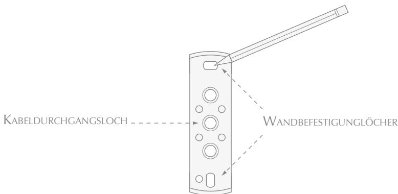
**3)** Die Platte entfernen und die soeben angezeichneten Löcher in die Wand bohren.
