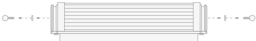
Снять стеклянный плафон, вывернув два винтовых зажима (с соответствующими шайбами) на краях светильника.
