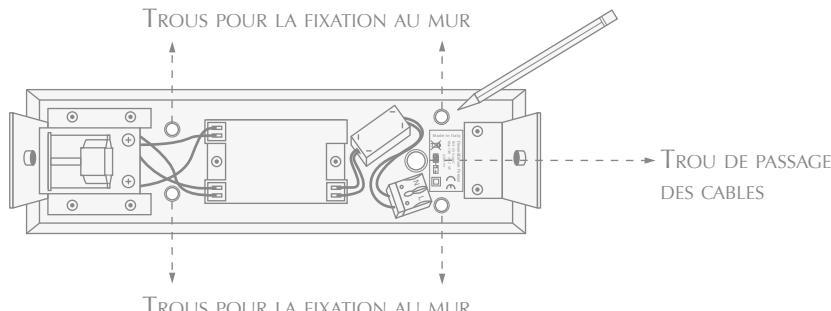
**3)** Enlever la partie arrière de la lampe et réaliser les trous dans le mur selon le traçage à peine effectué.
