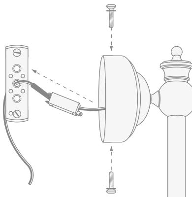
**8)** Faire attention à la présence de deux trous près du trou de fixation dans la partie inférieure du corps de la lampe : un trou est destiné à la fixation, alors que l'autre est prévu pour obtenir le degré de protection IP21 avec le kit optionnel.
