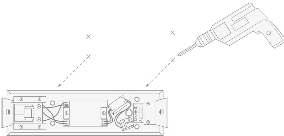
**4)** Inserire i tasselli a muro, posizionare la parte posteriore della lampada e fissarla a muro, avendo cura di far passare i cavi della rete di alimentazione dal foro apposito.
