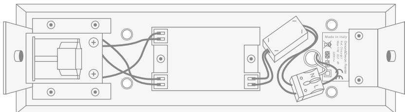
Nous vous rappelons que l'appareil appartient à la classe II et que le branchement au terminal de mise à la terre n'est pas nécessaire.
