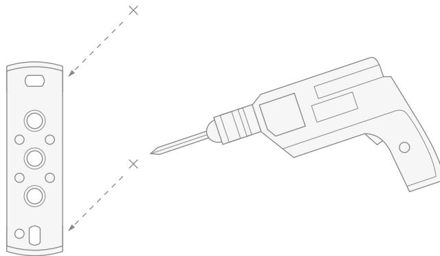
**4)** Introduire les chevilles dans le mur, positionner la plaque et la fixer au mur, veillant à faire passer les câbles du réseau d'alimentation par le trou prévu à cet effet.
