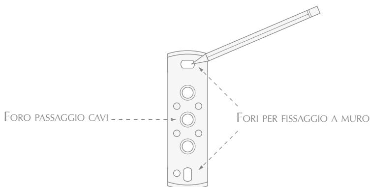
**3)** Rimuovere la piastra ed eseguire le forature a muro secondo la tracciatura appena eseguita.
