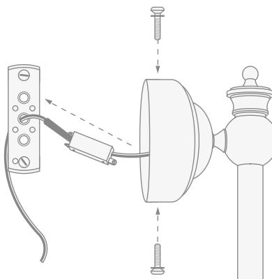
**8)** Fate attenzione al fatto che vicino al foro di fissaggio nella parte inferiore del corpo lampada ci sono due fori: uno è destinato al fissaggio e l'altro è il foro che è previsto per ottenere il grado di protezione IP21 insieme all'apposito kit opzionale.
