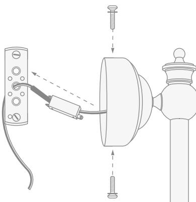
**8)** 8) Ponga atención en que cerca del agujero de fijación, en la parte inferior del cuerpo de la lámpara hay dos agujeros: uno es para la fijación y el otro es el agujero previsto para obtener el grado de protección IP21 junto al específico kit extra.
