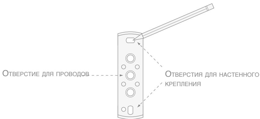
**3)** Отнять держатель и просверлить отверстия в стене по отметкам.
