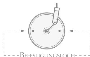
Befestigung für Leuchte Dover ohne Platte: es sind zwei Befestigungsbohrungen direkt am Gehäuse der Leuchte vorhanden.
