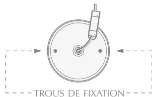
Fixation pour lampe Dover sans plaque: deux trous de fixation sont directement présents sur le corps de la lampe.
