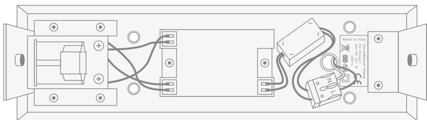
Напоминаем, что светильник имеет класс защиты II и, следовательно, не требуется подключение к заземлению.
